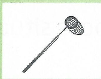
(Fig. 2) Mango de espejo dental modificado para filtro cestillo
